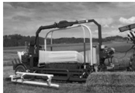
Rys. 6. Owijarka G3010-Q firmy Goweil Maschinenbau podczas owijania beli prostopadłościennej Źródło: fotografia firmowa.
