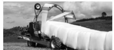
Rys. 9. Owijarka szeregową firmy Anderson podczas owijania bel prostopadłościennych Źródło: fotografia firmowa.
