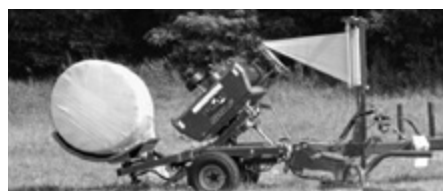
Rys. 3b. Owijarka samozaładowcza Spin F ze stawiaczem bel firmy SaMASZ Źródło: fotografia firmowa.
