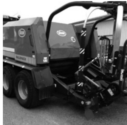
Rys. 5. Owijarka nbudowana na prasie RF 135 BalePack firmy Vicon Źródło: fotografia firmowa.
