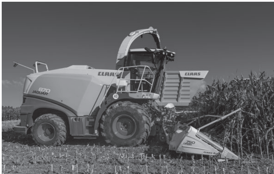
Fot. 5. Sieczkarnia samojezdna Claas z zespołem rzędowym
