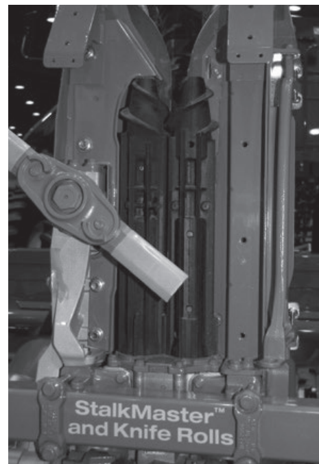
Fot. 1. Zespół obrywający kolby kukurydzy z nożem rozdrabniającym łodygi firmy John Deere
